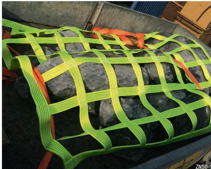
Sicherungsnetz mit YL Band, LC 2500/5000 daN. Im Garten- und Landschaftsbau müssen die verschiedensten Güter, wie Pflanzen, Baumaterialien, Baumaschinen und Werkzeuge zu den Einsatzorten gebracht werden. Ladungssicherungsnetze sind flexibel einsetzbar; besonders geeignet für Findlinge, Quadersteine usw.
