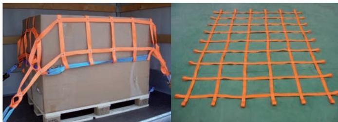
Zurrsnetze zur Ladungssicherung aus 35 mm Zurrband. Maschenweite 200 x 220 mm, Rand mit doppeltem Gurtband geführt, 12 cm Schlaufe alle 22 cm. Auf Anfrage in individuellen Größen erhältlich.
