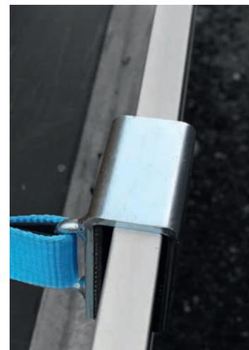
Bordwandhalter für Ladungssicherung ohne Platzverlust - exakte Abstimmung an die Ladung und ohne Beschädigung der Ladung. Besteht aus 395B RH und LH zwischen dem 50 mm Band mit Ratsche R320 in diversen Längen erhältlich.
