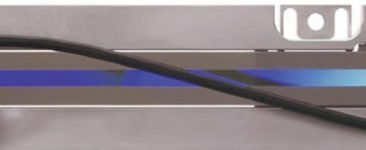
Die Zwei-Koordinaten-Messgeräte **PP** verwenden als Maßverkörperung eine flächige Phasengitterstruktur auf einem Teilungsträger aus Glas. Dadurch ist die Positionserfassung in der Ebene möglich.
