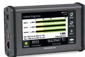
Für den mobilen Einsatz geeignetes Testgerät PWT 101
