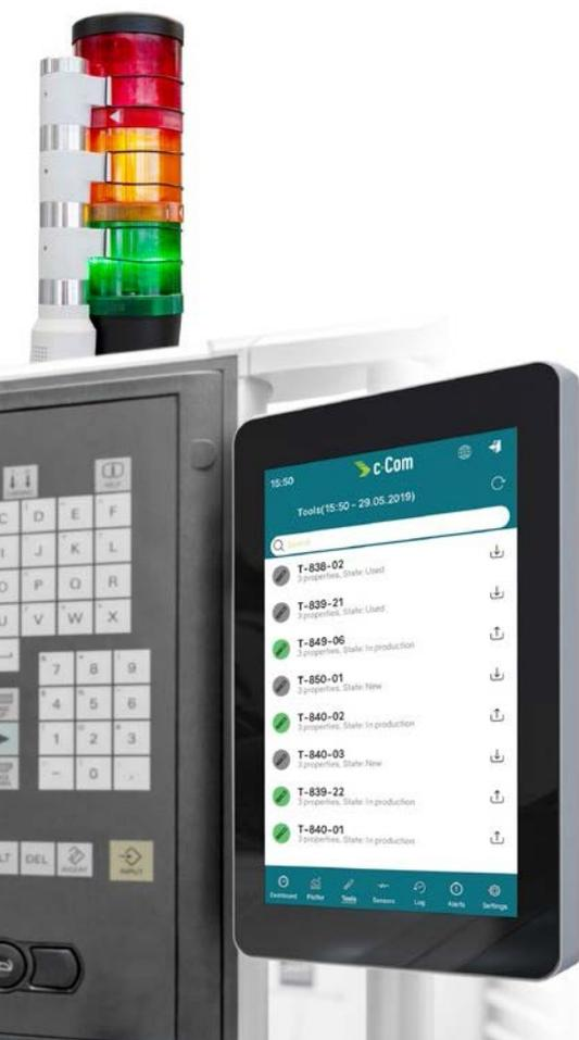
Der Einsatz von c-Connect zahlt sich für Kunden gleich mehrfach aus. c-Connect ermöglicht zum einen die digitale Übertragung der Werkzeugmessdaten vom Einstellgerät zur Maschine inklusive der Registrierung der Bestandsbewegungen. Zum anderen kann mit der c-Connect Box dank verschiedener Sensoren unter anderem der Maschinenstatus überwacht werden.
