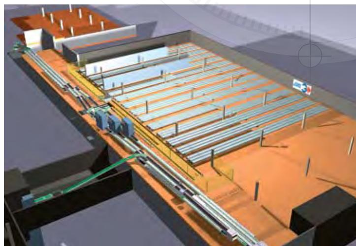
**Hochleistungsfördersystem mit Standard-Systemelementen**
