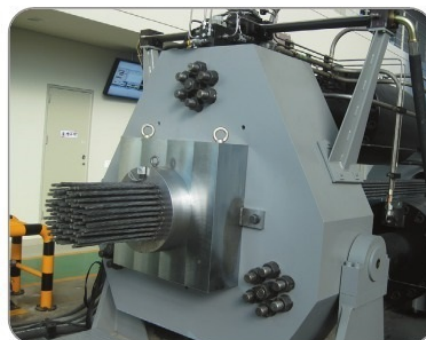
3000톤 케이블 시험기를 이용한 앵커헤드 / 정착재기 성능평가(100Heal)
