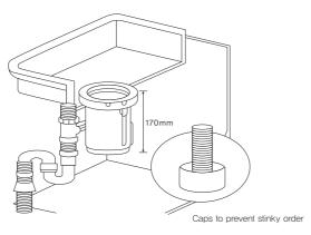
※ Sink hole diameter: Ø161mm∼Ø162mm Drainage body: Ø 185mmX170(H)mm
