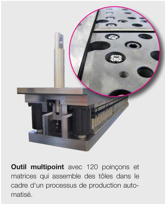
**Outil multipoint** avec 120 poinçons et matrices qui assemble des tôles dans le cadre d'un processus de production automatisé.
