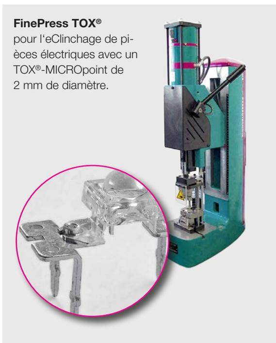
**FinePress TOX®** pour l'eClinchage de pièces électriques avec un TOX®-MICROpoint de 2 mm de diamètre.
