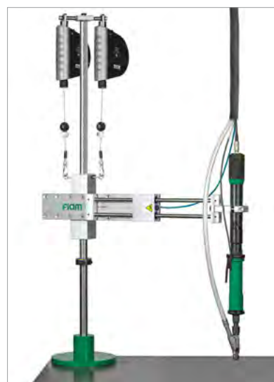
BC40 LK con dispositivo di blocco pneumatico per avvitatori autoalimentati auto avanzanti
