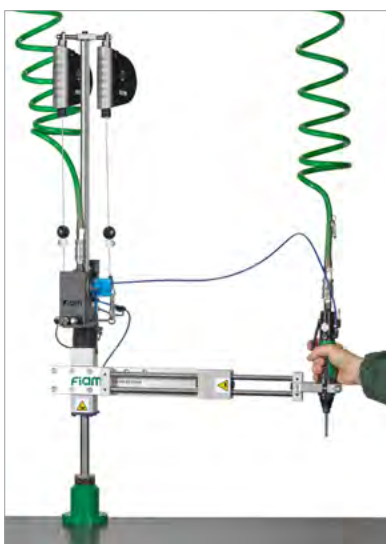
BC25PK con dispositivo di spinta pneumatica
