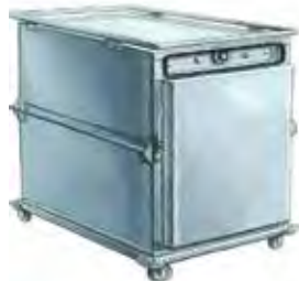
10024 Etuve électrique ventilée 16 grilles Electrique 220 V / 16A monophasé - 3,6 kW. 1 prise. Température maxi : 200°C en 90 min. Livrée avec 16 grilles pâtissières. Ext. : L 79 ; l 125 ; H 130 cm. Int. : L 60 ; l 80 ; H 85 cm. 217 Kg
