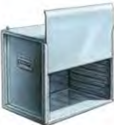
198 Conteneur traiteur Livré avec 8 grilles pâtisseries 60 x 40 cm. Espace entre les grilles : 6,5 cm. Possibilité de mettre un tiroir chauffant. Ext. : L 66 ; l 43 ; H 71 cm. Int. : L 60 ; l 41 ; H 64 cm. 21 Kg
