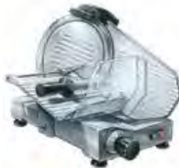
13341 Trancheur à jambon professionnel 220 V - 370 W / 16 A. Ext : L 62 ; P 72 ; H 53 cm. Lame de coupe Ø 35 cm. 36 Kg
