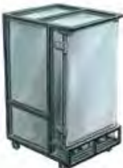
409 / 229 Etuve morice mixte Livrée avec 8 grilles. Espace entre les grilles : 8 cm. Ext. : L 74 ; l 96 ; H 135 cm. Int. : L 60 ; l 80 ; H 95 cm. 143 Kg Gaz (0229) : 1 bouteille de gaz butane (20 Kg). Détendeur de 28 mbar. Équipée d'une sonde thermostatique pour le gaz, les rampes se coupent à 180°C et se rallument à 160°C. Electrique (0409) : 220 V / 16A monophasé - 4,5 kW. Répartis entre 2 prises (1,5 kW et 3 kW)
