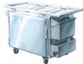
11527 Etuve électrique petit modèle 220/230 V - 16 A monophasé - 2 kW Température maxi 150°C en 30 min - Combiné adaptable pâtissière ou gastronorme 1/1. Fourni avec 5 grilles pâtissières 60 x 40 cm. Espace entre les grilles : 7 cm. Ext. : L 89 ; P 50,5 ; H 73 cm. Int. : L 60 ; P 40 ; H 45,5 cm
