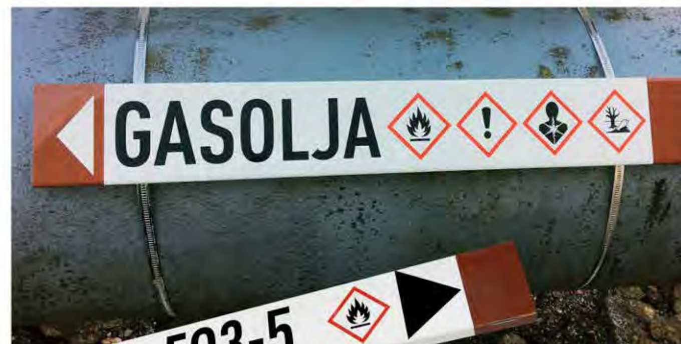
De kantbockade skyltarna fästs med spännband genom slitsarna i plåten.
