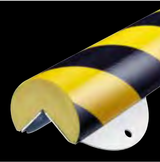
Väggskydd A+ Ø60 mm. Inermått 35x35 mm. På stålprofil som skruvas fast.. Gul/svart 0,5 m (1 m) .....WPK-A+05 (1) Röd/vit reflex 0,5 m (1 m).... WPKR-A+05 (1)
