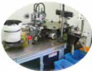
■ Gas Spring C-Clip 자동조립기 1~7호 ■ Gas Spring C-Clip Auto Assembly Machine 1-7 Number
