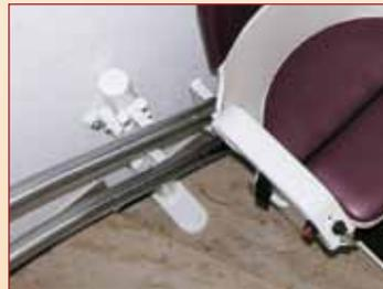
**Wandbefestigung mit aufgestellten Stützen:** Hier werden die Stützen mit einem Winkel an der Wand verschraubt. Da sie auf der Treppe lediglich aufgestellt werden, um das Gewicht abzufangen, bleiben die Stufen unversehrt.
