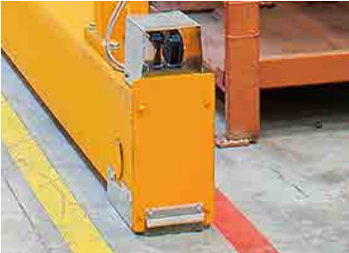
Hinderniserkennung am unteren Fahrwerksträger serienmäßig und keine Führungsschiene am Boden erforderlich.
