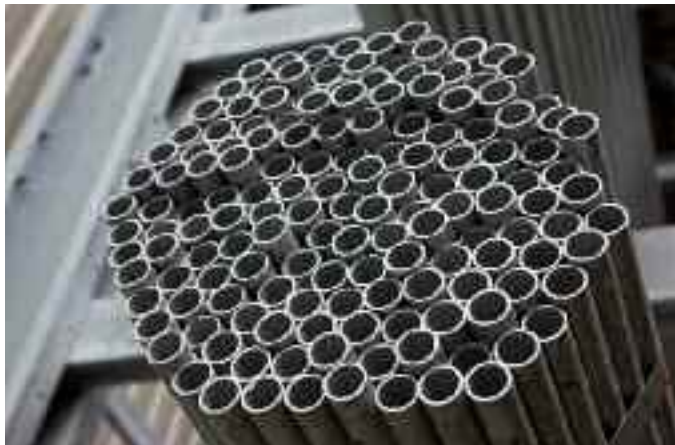
Protection anti-corrosion de tubes en bottes, par immersion
