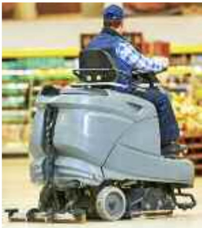
Lavage de sols sur laveuses autoportées, avec contrôle du fil d'eau Lavage sur autolaveuses robotisées
