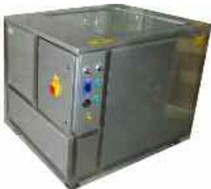
Dégraissage, nettoyage, lavage des composants mécaniques en machine ultrasons avec générateurs piézo-électriques ou magnétostrictifs
