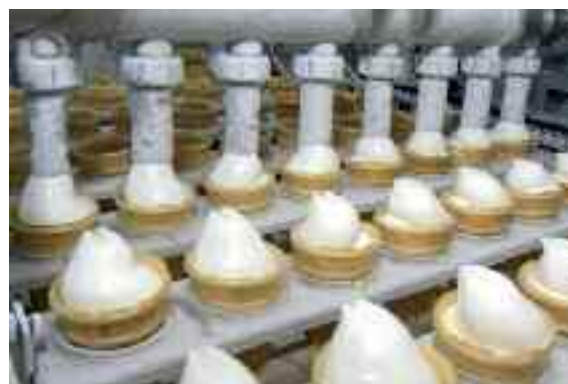
Nettoyage des buses de conditionnement de crème glacée pour une garantie de poids constants
