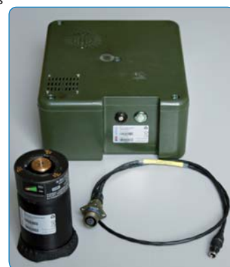
Conjunto con pila de hidrógeno
