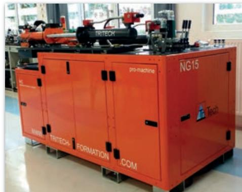
Le **nouveau banc de simulation** possède un moteur électrique à vitesse variable rendant possible l'intégration de pompes en circuit fermé, équipées de régulation automobile. Côté récepteur, l'alternance des charges résistantes et motrices permet d'expliquer l'intérêt des valves de retenue de charges. Grâce aux capteurs (déplacement - pression - vitesse), l'évolution en temps réel des paramètres illustre les phénomènes décrits dans la partie théorique.
