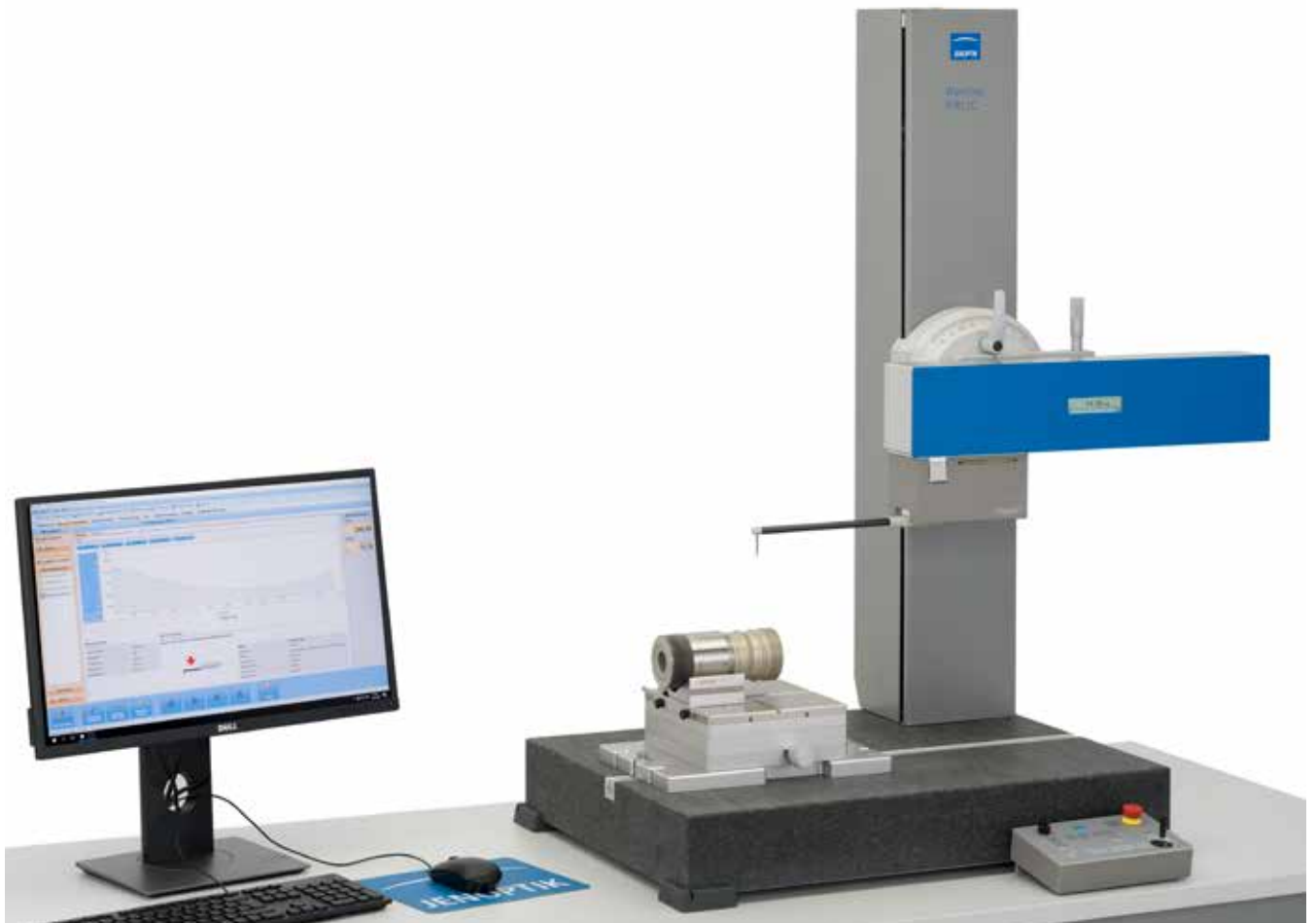
Waveline W812C Digiscan mit 500 mm-Messsäule, 120 mm-Vorschub, Bedienpult und Zubehör zur Werkstückaufnahme
