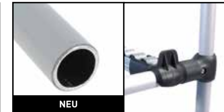
BESCHICHTET - GRAU KOMPATIBEL MIT LEANTEK classic 2MM WANDSTÄRKE, Ø28.6MM, 4000MM LÄNGE - Art.Nr. T2-400 AG
