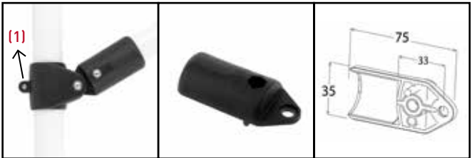
F-G BLACK (mit F-F montiert) (1) MIT SCHRAUBE S14W ZU BEFESTIGEN STANDARD GELENKVERBINDER FÜR BELIEBIGE WINKEL (Teil B) - 22 g
