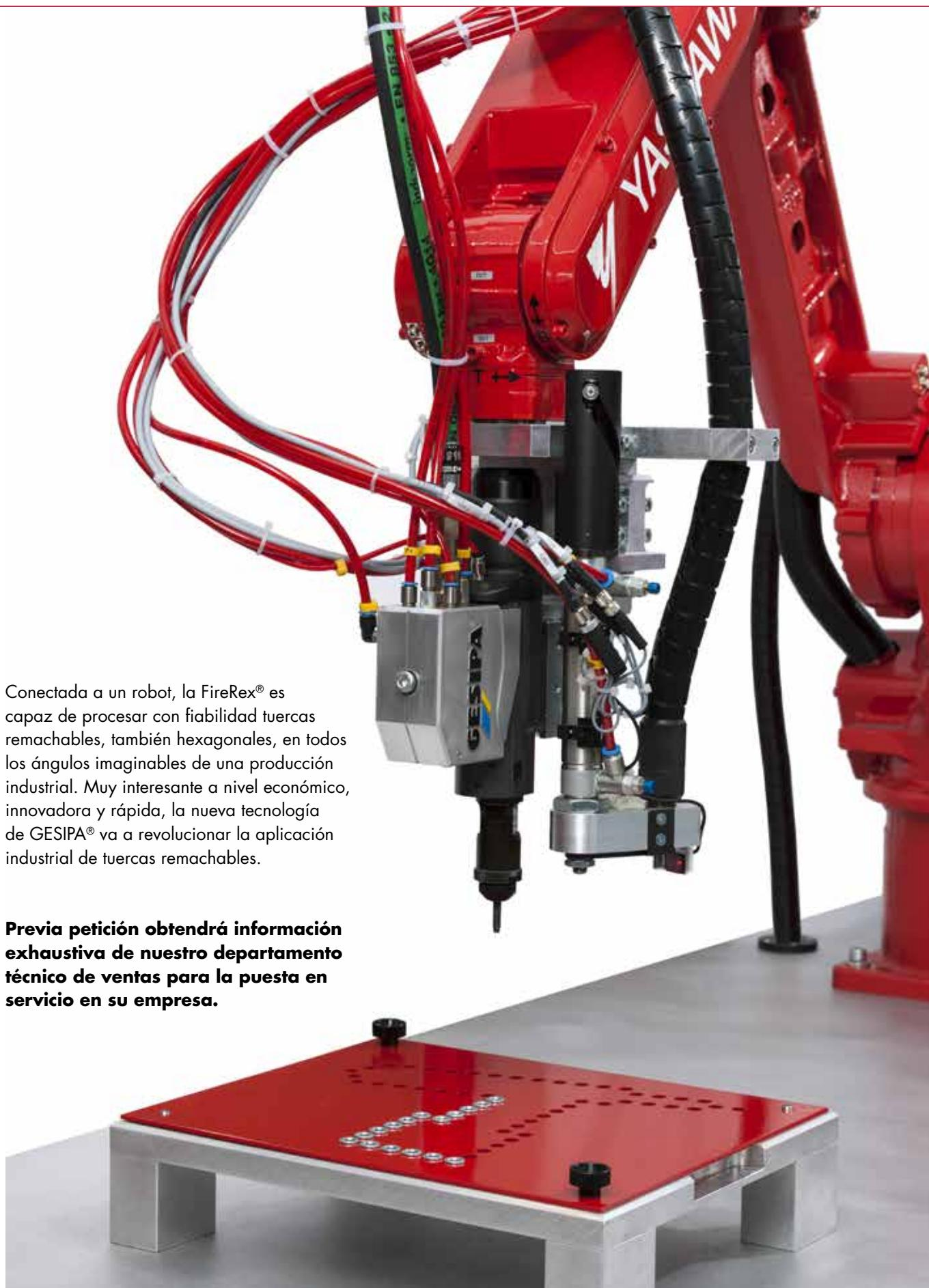
Conectada a un robot, la FireRex® es capaz de procesar con fiabilidad tuercas remachables, también hexagonales, en todos los ángulos imaginables de una producción industrial. Muy interesante a nivel económico, innovadora y rápida, la nueva tecnología de GESIPA® va a revolucionar la aplicación industrial de tuercas remachables.
