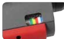
**NOVEDAD** ajuste rápido y exacto de la fuerza de tracción a través de un código de colores visible por un lado de la cabeza de la remachadora
