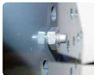
La tuerca ligeramente presionada contra el mandril se enrosca automáticamente.
