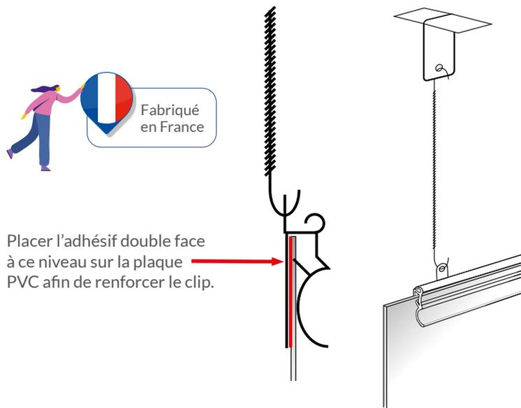
Placer l'adhésif double face à ce niveau sur la plaque PVC afin de renforcer le clip.
