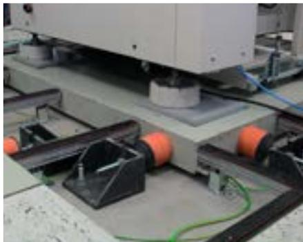
Begrenzung der horizontalen Schwingbewegungen von, auf IPK 66 gelagerten, Fundamenten für Maschinen der Elektronikteileherstellung.
