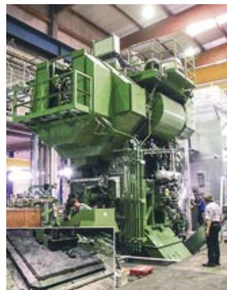
EUMUCO-Schmiedepresse auf isoloc Pressenlagerungssystemen mit komplettem Medienschutz.
