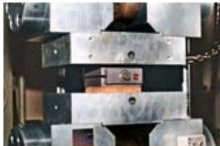
Messen der Verstelldrehmomente beim Nivellieren der isoloc UMS Universal-Präzisions-Maschinenschuhe bei unterschiedlichen Belastungen. Ebenso wird die maximale Belastung bis zum Bruch ermittelt (LGA Nürnberg).
